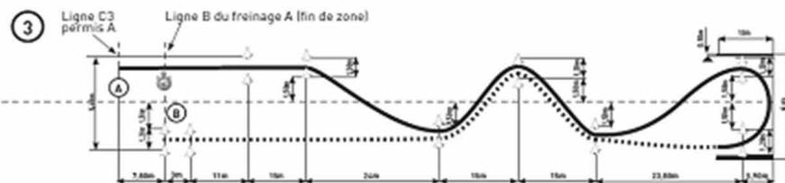
Effectuer à allure normale, sans passager, le parcours de A en B. Rétrograder en 2<sup>ème</sup> puis en 1<sup>ère</sup> avant arrêt en relâchant l'embrayage après chaque changement de vitesse.
